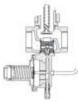
**Posición** para la instalación del regulador en cañerías horizontales.
