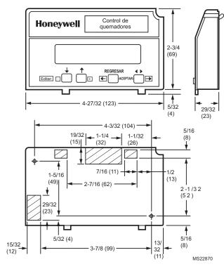
Fig. 1. Dimensiones aproximadas de S7800A1167 en pulgadas (mm).
