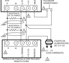
ES POSIBLE QUE SE NECESITE UN CABLE PROTEGIDO DE TRES HILOS. SE NECESITAN DOS RESISTENCIAS TERMINALES DE 120 OHMIOS PARA CONEXIONES DE MÁS DE 100 PIES (30 M). EL CABLE PROTEGIDO DEBE TENER UNA CONEXIÓN A TIERRA EN AMBOS EXTREMOS. SI NO SE USA EL CABLE PROTEGIDO. SE DEBE USAR UN CABLE DE PAR TRENZADO.
