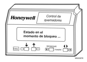
Fig. 17. Mensaje de bloqueo, estado 2.
