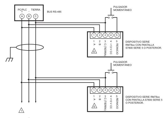
BUS DE COMUNICACIÓN RS-485 MULTI-DROP. ES POSIBLE CONECTAR HASTA 31 PANTALLAS S7800 SERIE 5 O POSTERIOR A UN SOLO BUS SIN UN REPETIDOR RS-485. ES POSIBLE CONECTAR HASTA 99 MODBUS™ (SUBREDES) A UN BUS CON REPETIDORES RS-485. CUANDO SE USA UN REPETIDOR RS-485, ÉSTE SE DEBE INSTALAR CADA 30 MÓDULOS.
