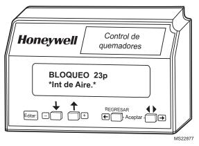
Fig. 16. Mensaje de bloqueo, estado 1.
