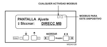
Fig. 31. Actividad ModBus vista en la pantalla Setup.
