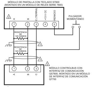
ES POSIBLE QUE SE NECESITE UN CABLE PROTEGIDO DE TRES HILOS. SE NECESITAN DOS RESISTENCIAS TERMINALES DE 120 OHMIOS PARA CONEXIONES DE MÁS DE 100 PIES (30 M). EL CABLE PROTEGIDO DEBE TENER UNA CONEXIÓN A TIERRA EN AMBOS EXTREMOS. SI NO SE USA EL CABLE PROTEGIDO, SE DEBE USAR UN CABLE DE PAR TRENZADO.
