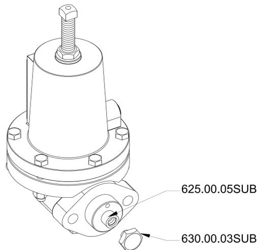
6-Una vez reemplazados los elementos armar la unidad siguiendo las instrucciones en orden inverso. Es importante que la toma de presión (625.00.08) no se aplaste en el armado (la misma debe quedar en la misma posición del inicio).
